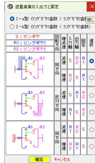
図 58.4 3K 遊星歯車機構のタイプの選択
