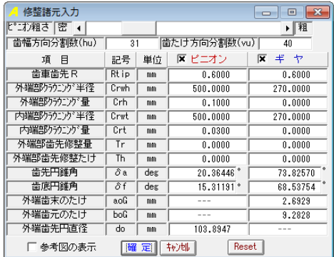
図 21.4 修整諸元設定
