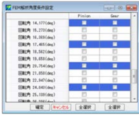
図 45.43 FEM 解析角度の設定
