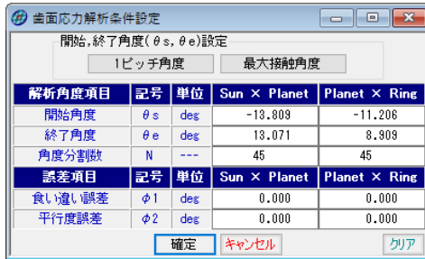
図 49.21 歯面応力解析条件設定
