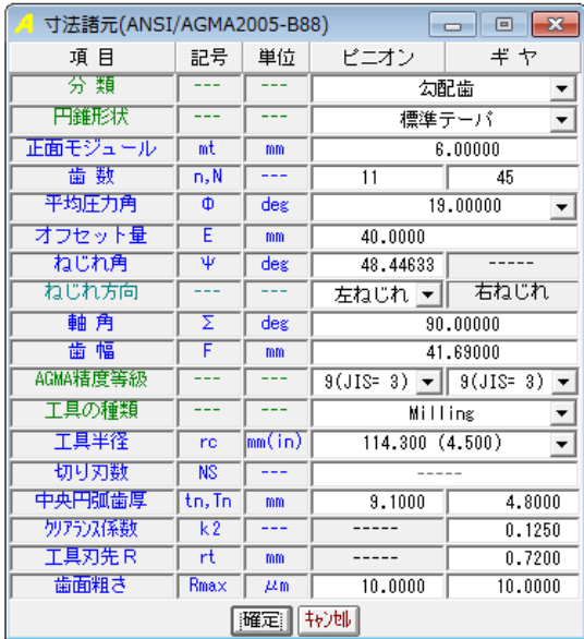
図 21.2 寸法諸元設定
