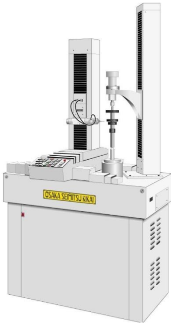
図 25.2 歯車測定機(CLP-35:大阪精密機械(株)様ご提供)
