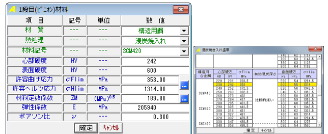
図 40.5 材料設定の例
