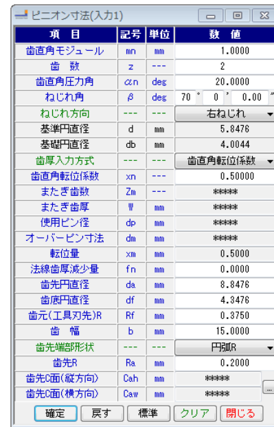
図 20.36 ピニオン諸元と寸法
