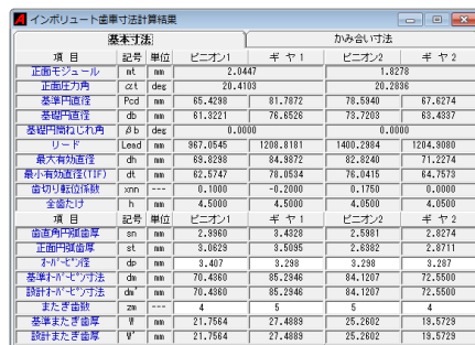
図 38.7 インボリュート歯車寸法（基本寸法）
