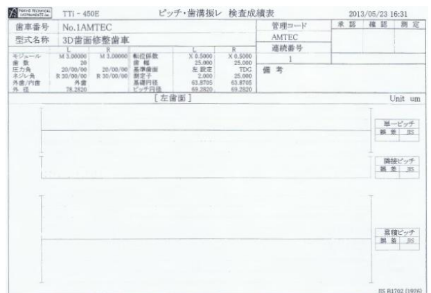
図 104.9 検査結果 (ピッチ誤差, 左歯面)
