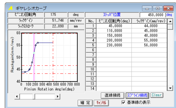
図 19.7 ギヤレシオカーブ(スプライン接続)
