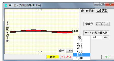
図2.37 ピッチ誤差の設定 (最大値設定)
