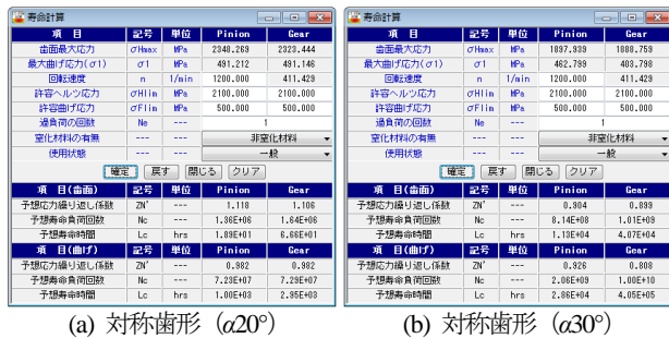
(a) 対称歯形 ( \alpha 20^\circ ) (b) 対称歯形 ( \alpha 30^\circ ) 図H.30 寿命計算結果
