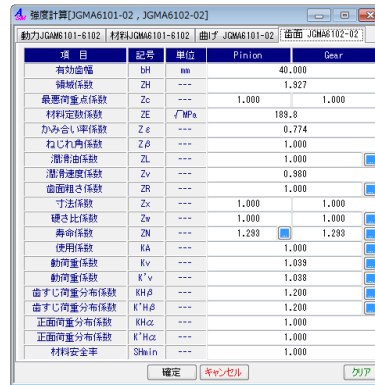
図 4.21 強度計算 (面圧に関する係数)
