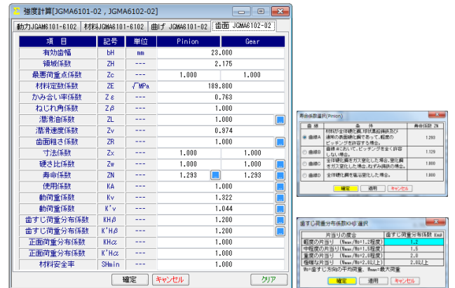
図 1.20 強度計算 (面圧に関する係数)
