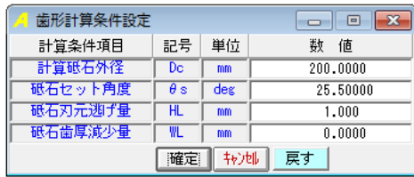
図 16.21 砥石齒形の計算条件
