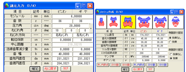
図 A.5 諸元設定 図 A.6 メッシュ作成諸元
