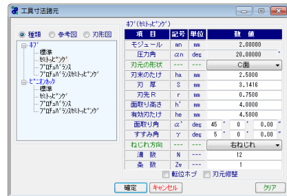
図 14.9 工具寸法諸元入力
