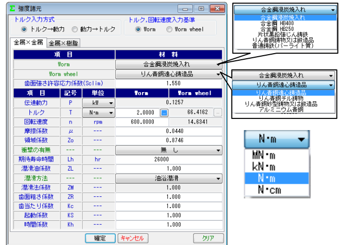
図 3.19 強度諸元 (金属×金属)
